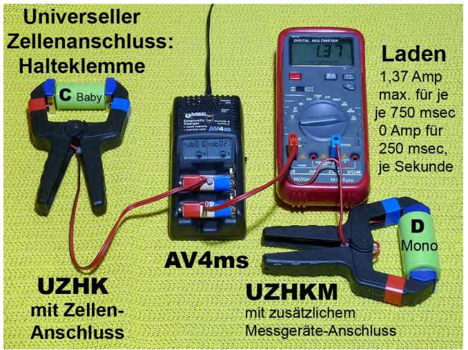
Die Nutzung des AV4ms / AV4m+ zum Laden der extern angeschlossener Zelle (max. 4 Zellen sind gleichzeitig möglich) erfordert allerdings etwas "Mit-Denken" des Anwenders, um sachtechnisch richtig die AV4ms / AV4m+ Möglichkeiten, aber auch die Geräte-Grenzen einzubeziehen.
